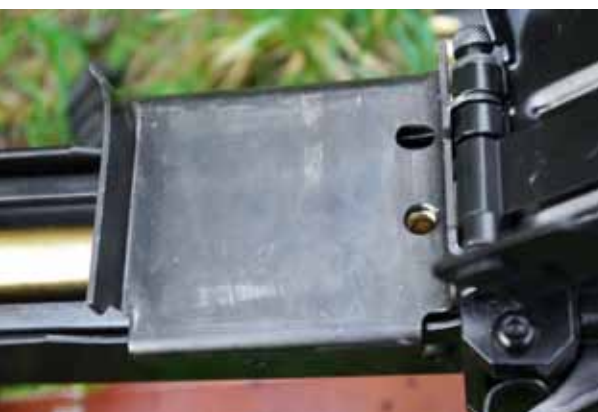
Ci-contre. Dans le couloir d'alimentation, le passage de bande ne peut pas accueillir de chargeur rond. Il faut acheter une pièce spéciale séparément.
